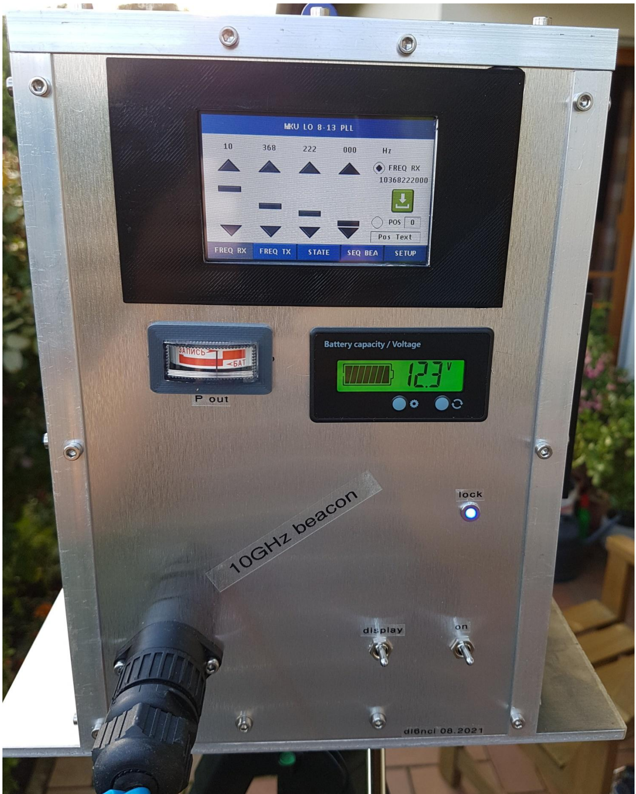
Frontplatte mit Touchdisplay, Spannungsanzeige, Outputanzeige. Ein Schalter um die PAs abzuschalten um während eines QSOs keine Störungen zu haben
