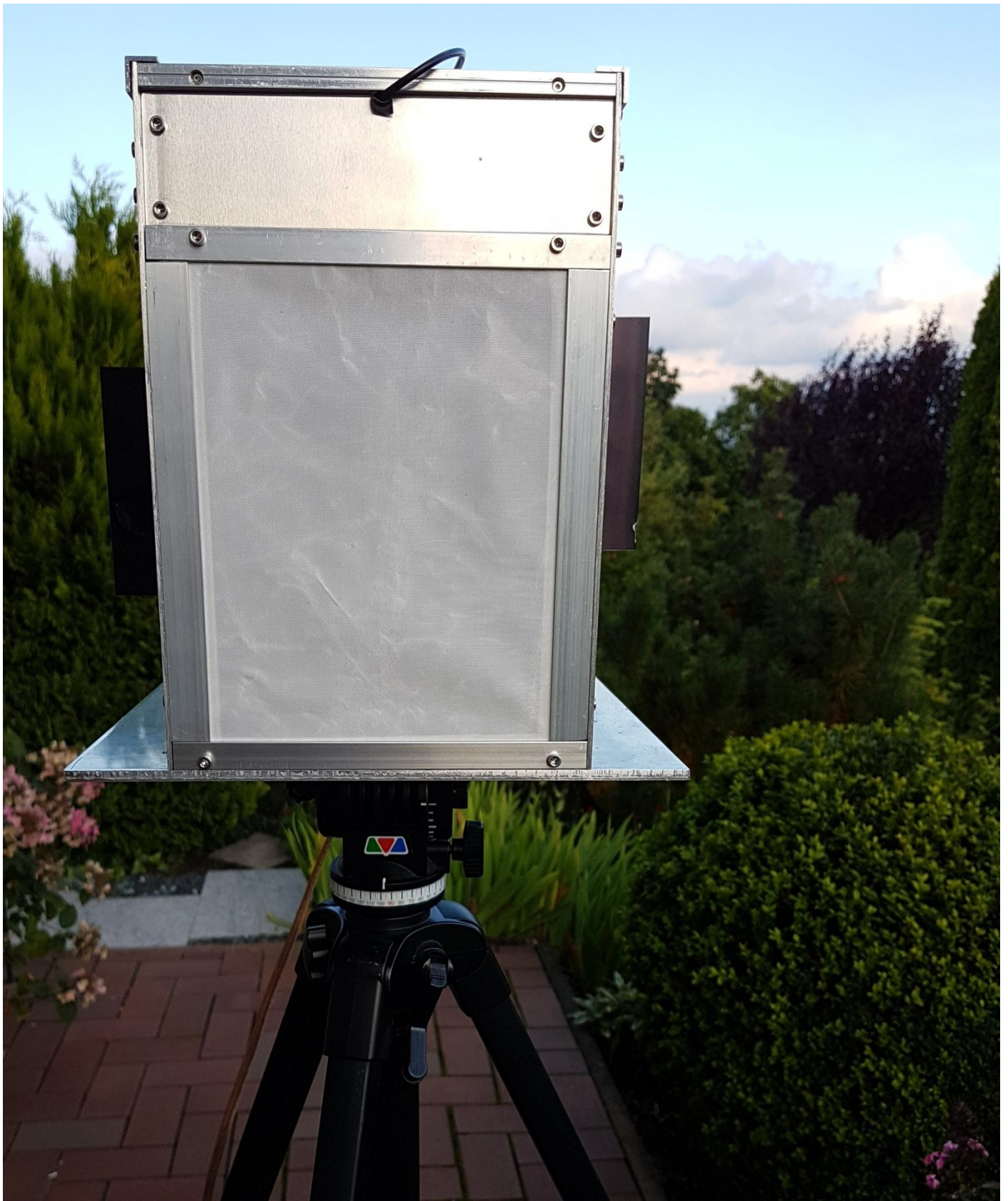
Die Antenne wurde mit dünner Teflonfolie abgedeckt
