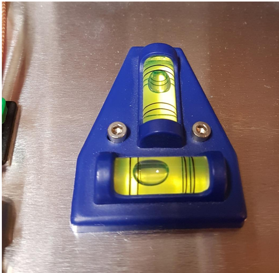
Fest montierte 2D Wasserwaage zum Ausrichten der Station
