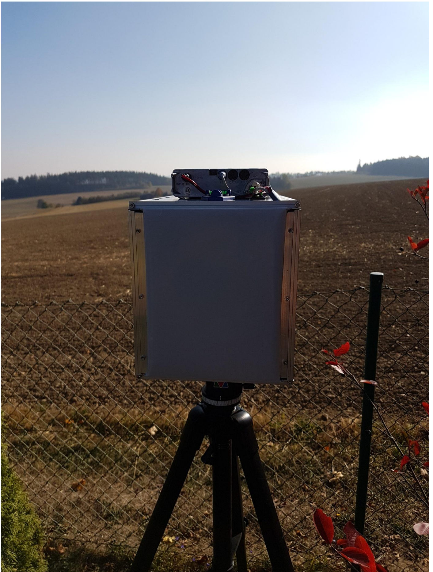
Hornantenne mit Abdeckung aus dünner Teflonfolie
