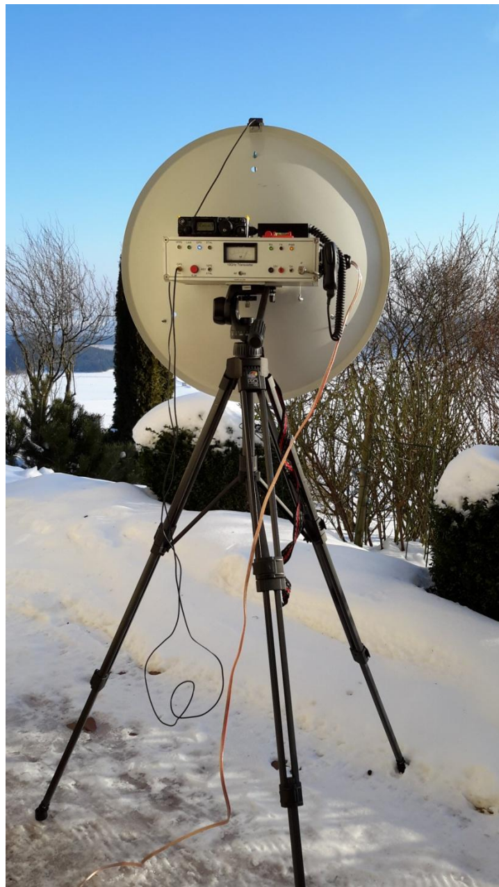
Üblicher Aufbau einer Portabelstation für \mu\text{W}
